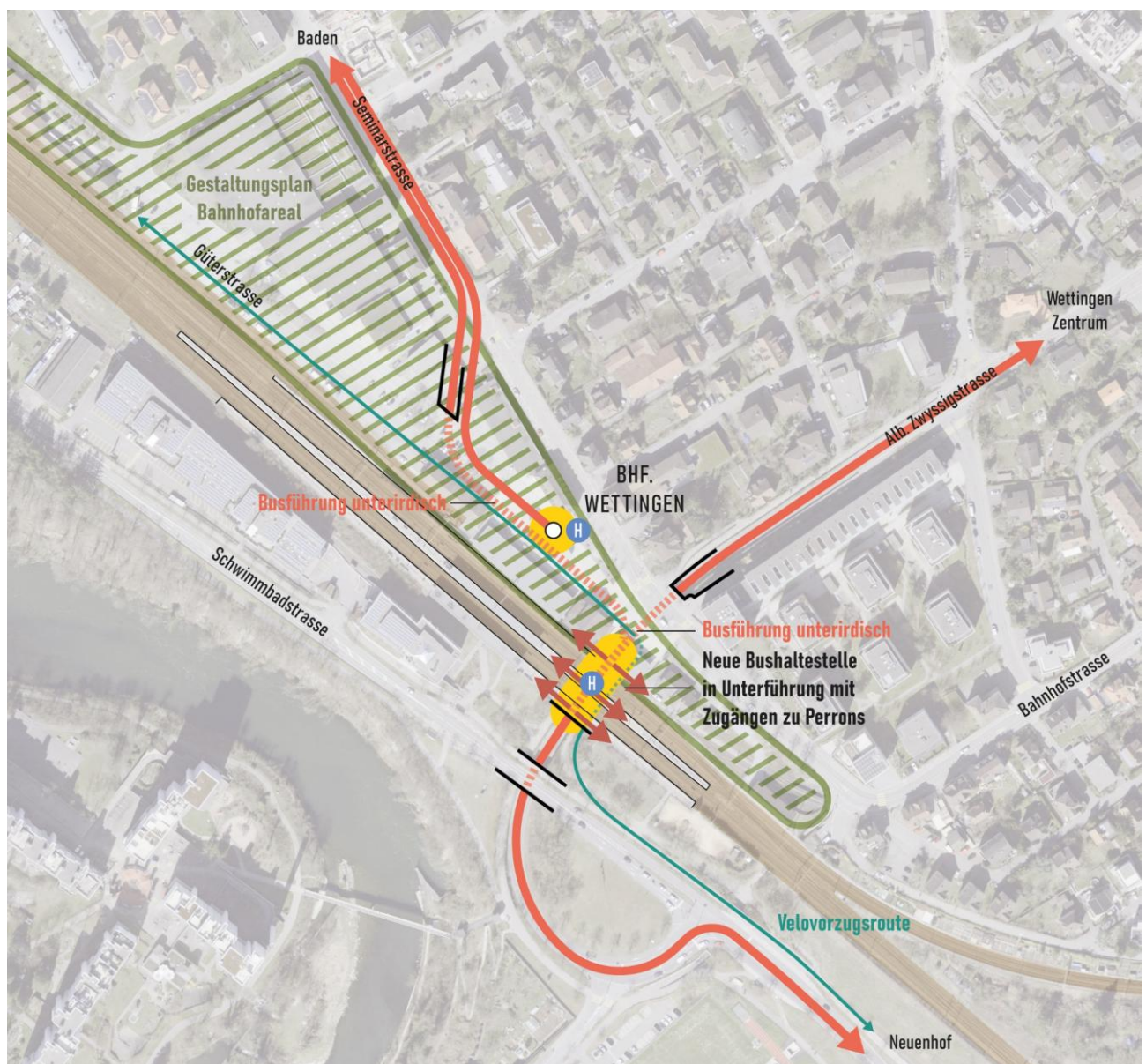
Abbildung 32: Prinzipschema der neuen Gleisquerung für öV-Busse und Veloverkehr an der Drehscheibe Bahnhof Wettingen
