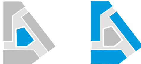
Abbildung 7: "Kern" (Massivbau) und "Mantel" (Holzbauweise)
