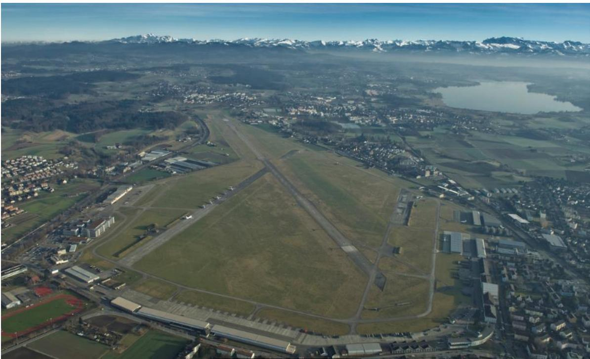
Der brachliegende Flugplatz Dübendorf verfügt über eine Hartbelag-Piste von 2775 m Länge welche aus Richtung Osten (29) über schwachbesiedeltes Gebiet angefliegen werden kann.
