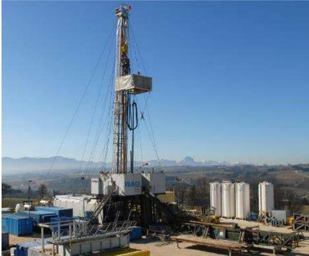
Destruktive Bohrverfahren werden zur Erdwärme-, Öl- oder Gasgewinnung eingesetzt und können Bohrlängen von über 10 km erreichen. Das vom Bohrkopf zerkleinerte Bohrgut wird mit Luftdruck oder der Bohrspülung an die Oberfläche transportiert und kann dort als Bohrklein ausgesiebt werden (vgl. Abbildung unten).
