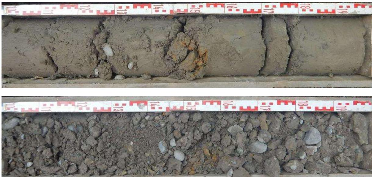
Durch den Bohrprozess wird der im Einfachkernrohr-Verfahren gebohrte Lockergesteins-Bohrkern äusserlich zerrieben. Äusserlich sieht der Kern deshalb homogen und aus feinkörnigem Material bestehend aus. Mit der Bohrkern-Reinigung respektive dem "Öffnen" des Bohrkerns, wird der Kies-Anteil im Kern sichtbar und der rostige Fleck in der Kern-Mitte erscheint nur noch als einzelnes, verwittertes Sandsteinbruchstück.
