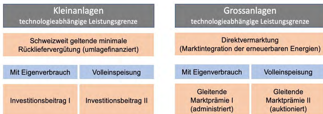
Abb 1: Das langfristige Finanzierungsmodell für Erneuerbare Kraftwerke muss zwischen Klein- und Grossanlagen unterscheiden. Kleinanlagen wird eine schweizweit einheitliche Einspeisevergütung gewährt und beim Investitionsbeitrag zwischen Eigenverbrauchsanlagen und Volleinspeisungsanlagen unterschieden. Grossanlagen werden zur Direktvermarktung verpflichtet und ermitteln die gleitende Marktpremie in einer wettbewerblichen Ausschreibung.
