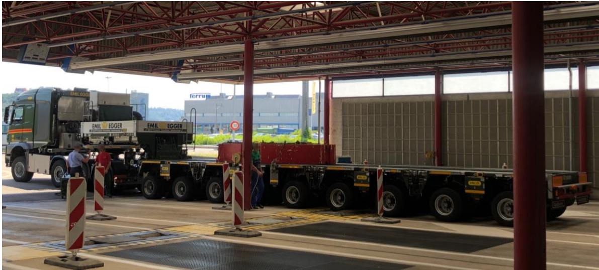
Abbildung 10 Spezieller Bremsprüfstand für mehrachsige Fahrzeuge
