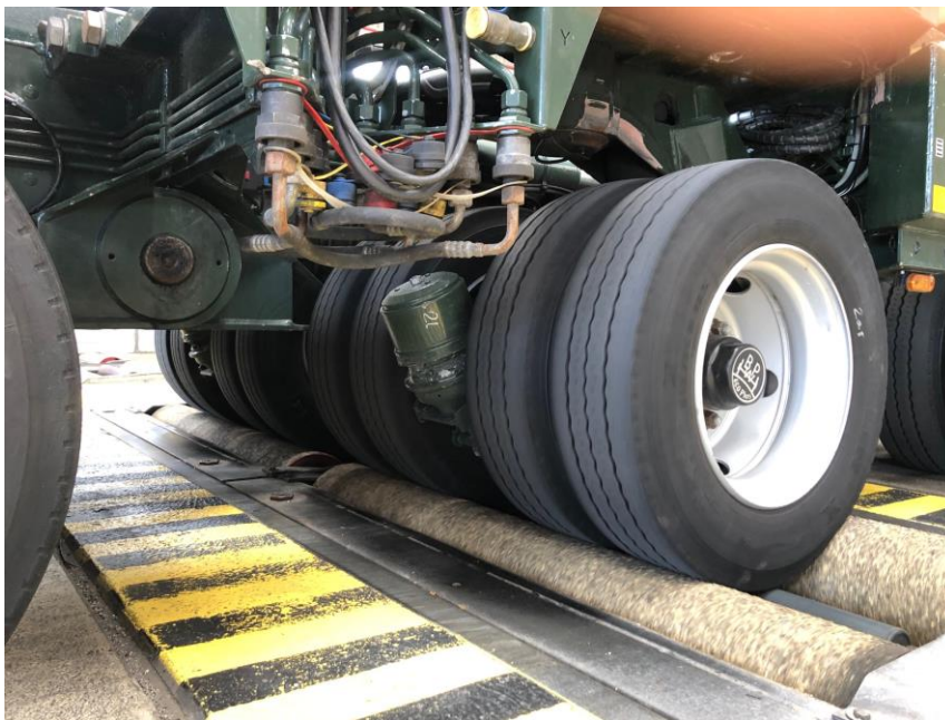
Abbildung 11 Achse mit acht Reifen benötigt speziell breite Rollen
